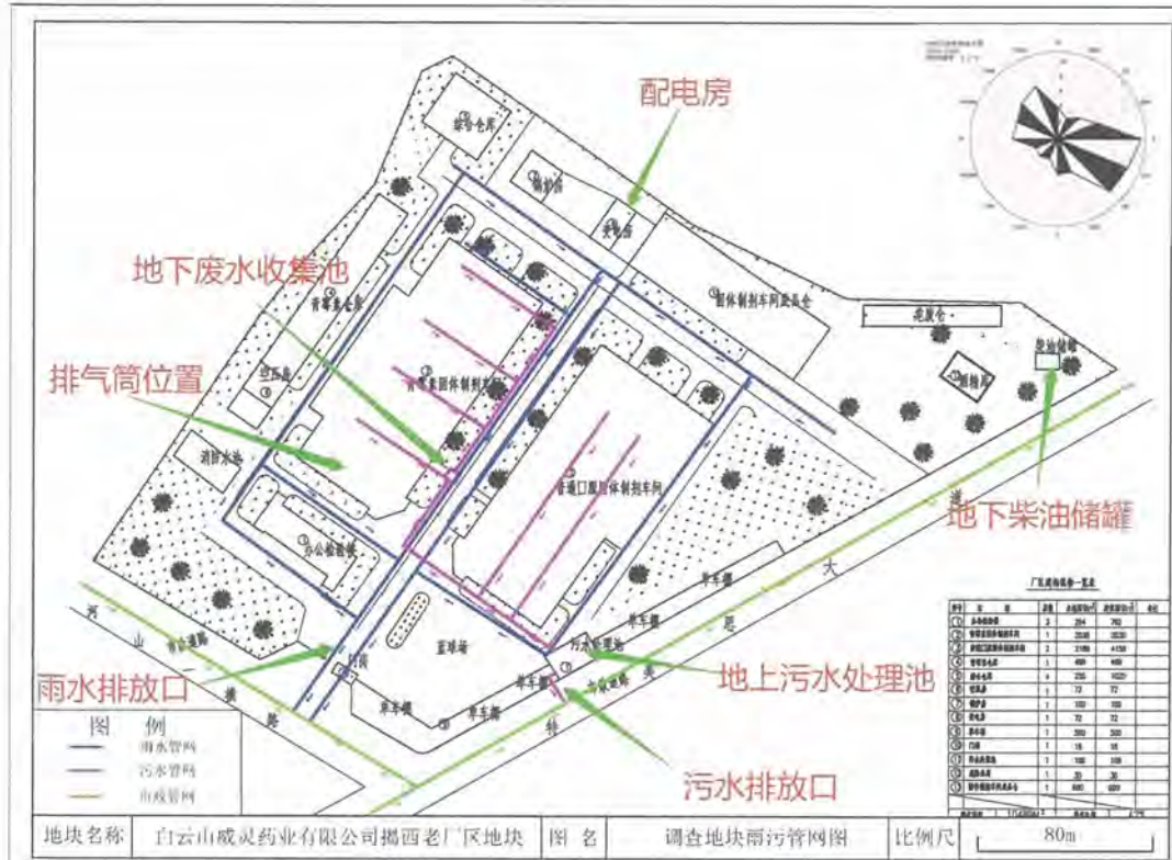
图 2.2.6-2 地块雨污管网及地下储罐、地下废水收集池、地上污水处理池分布图
